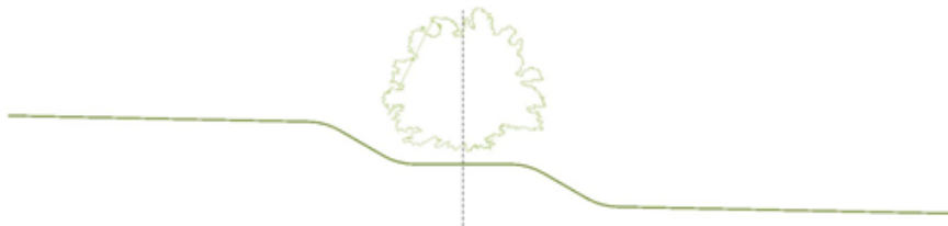
Mynd 9 Uppgefin landhæð skal vera á lóðamörkum. Sú landhæð skal að lágmarki ná 1 m inn á hvora lóð. Mögulegt er að hækka/lækka lóð að vild innan hennar.
